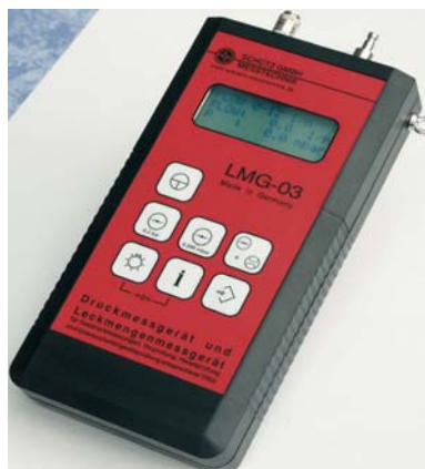
Φορητό όργανο ογκομέτρησης διαρροής αερίου με δυνατότητα σύνδεσης με PC και εκτυπωτή
